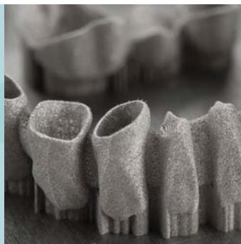
Struttura lasersinterizzata in lega Co-Cr
